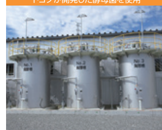
発酵槽 トヨタが開発した酵母菌を使用
