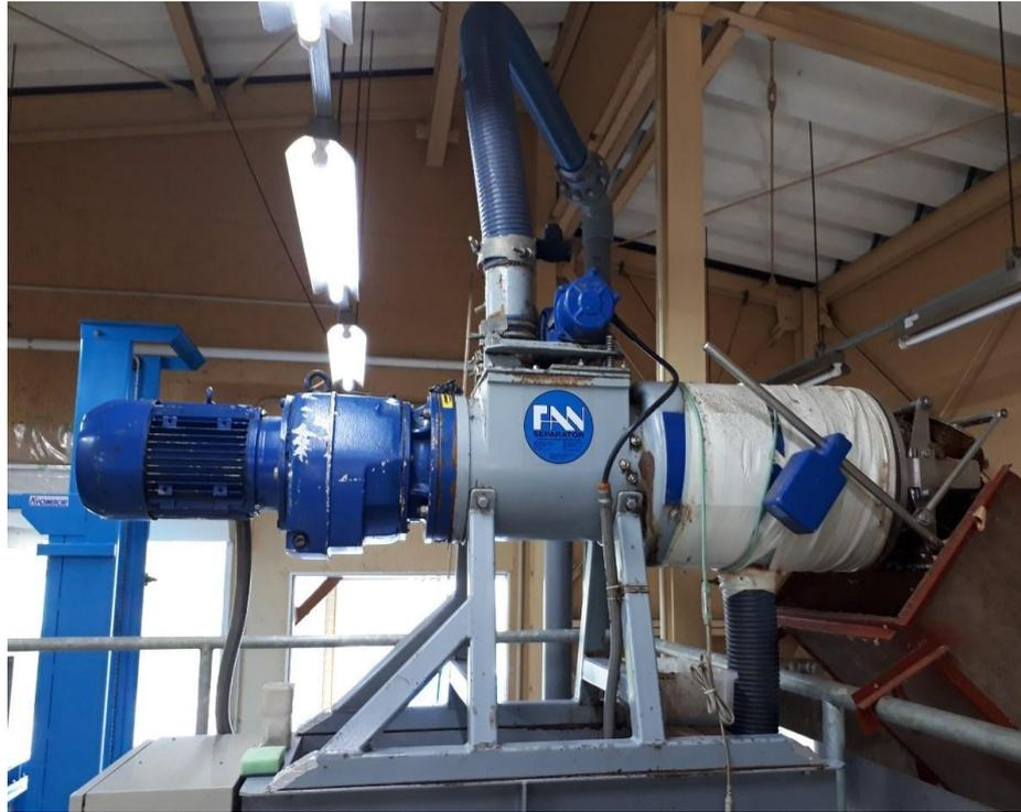
バイオガスプラント内固液分離装置
