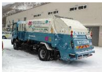
写真 (左)稚内市バイオエネルギーセンター (右)バイオガスで走るゴミ収集車両
