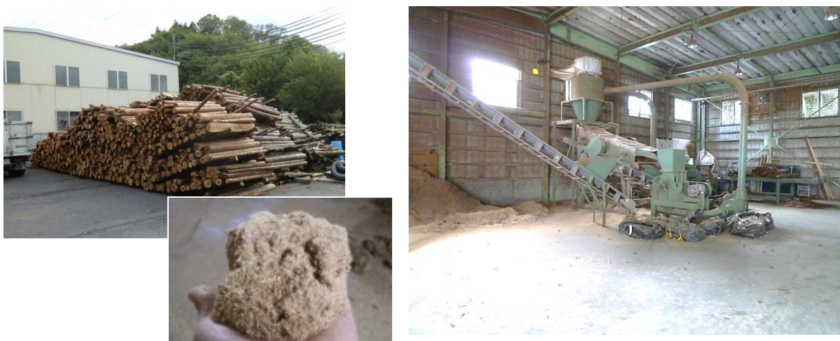
図 22(左)間伐材とオガコ、(右)オガコ製造機
