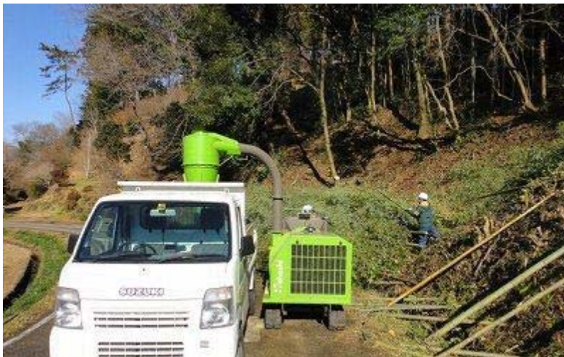
図 29 竹の破砕機(現場で粉碎、積込まで行える駆動型)
