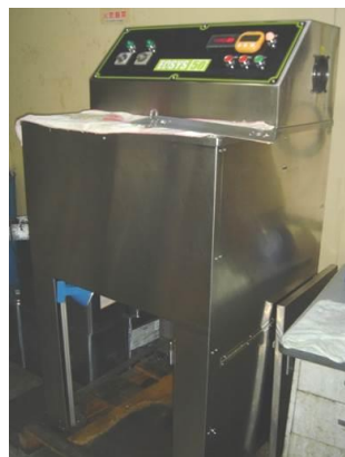
BDF 製造設備
