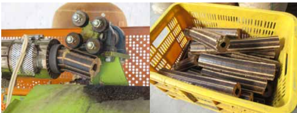
もみ殻の固形燃料化試験
