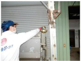
⑥甘皮を焙煎機に投入(庫内温度120~150℃、焙煎時間約20分)
